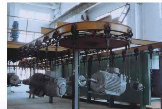
■ 装配喷漆流水线
