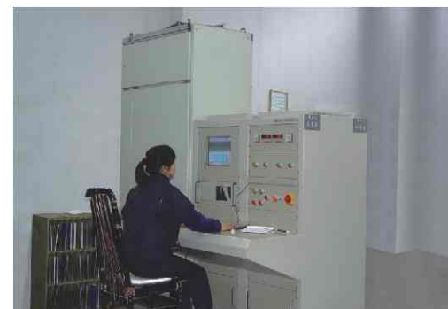
■ MT-D(I)电机出厂综合检测设备
